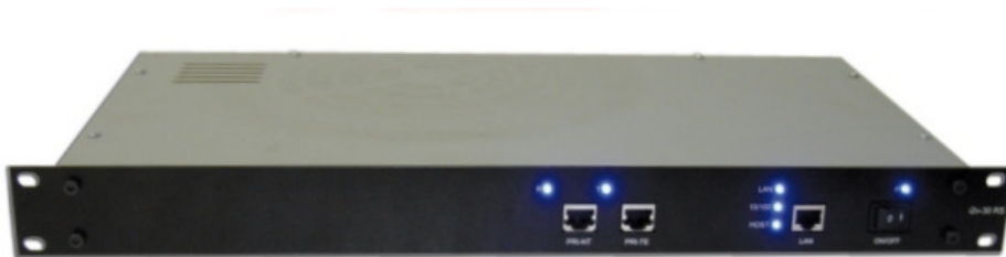
Checktel hardware: 19" behuizing: hoogte: 1U, frontkleur: zwart
